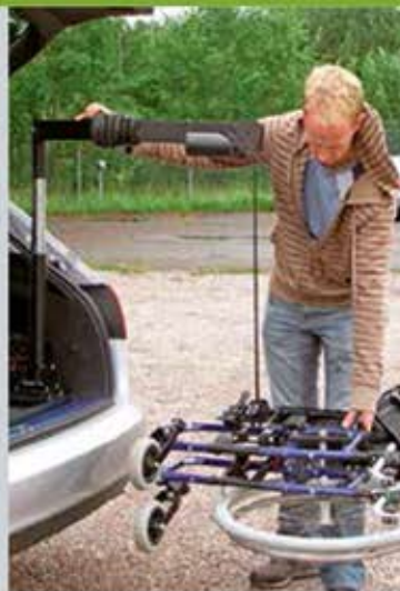
El brazo flexible de la grúa Carolift 40 para sillas de ruedas manuales hace que sea muy sencillo colocar la silla de ruedas en el espacio destinado a la misma.
